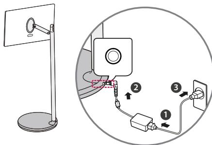
① Raccordez le câble d'alimentation à la source d'alimentation (adaptateur).
