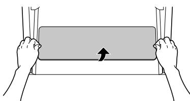
· 按照以下方式安装绒毛过滤器盖，使其导向标记(▽)朝向本电器正面。
