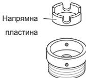
3 Притисніть перехідник на кінці крана таким чином, щоб гумова прокладка утворила водонепроникне з'єднання. Затягніть чотири гвинти кріплення.
