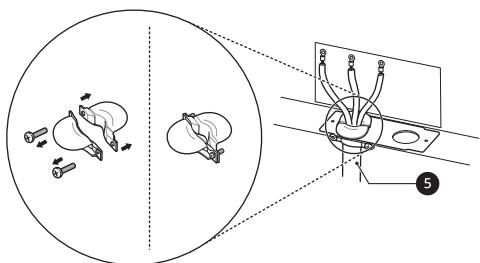
For conduit installations, insert the conduit strain relief in the 1 1/8 in. (2.8 cm) conduit hole. Then
