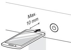
**3** Pulse y mantenga presionado el botón **Temp.** durante 3 segundos o más mientras sostiene el micrófono del teléfono inteligente junto al botón **Encendido/Apagado** hasta que la transferencia de datos finalice.
