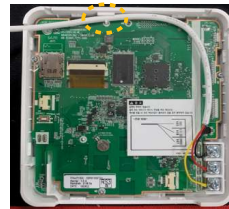
Le bossage central supérieur pour la fixation du câble plié
