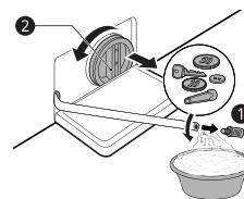
4 清理完排水泵过滤器后,装入排水泵过滤器并插入排水塞。
