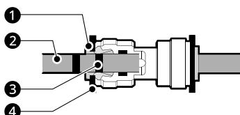
① Douille de serrage ② Tuyau ③ Insérer la conduite ④ Clip
