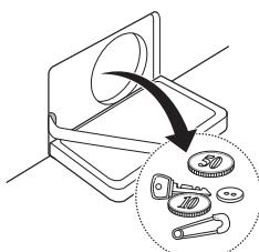
**4** Despues de la limpieza, gire el filtro de la bomba e inserte la manguera de drenaje.
