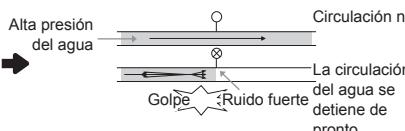
Ajuste la presión del agua cerrando la válvula de agua o el grifo del hogar.
