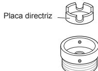
**3** Presione el adaptador contra el extremo del grifo de modo que el sello de goma forme una conexión hermética. Ajuste los cuatro tornillos de fijación.
