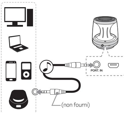
1. Raccordez le périphérique externe au connecteur d'entrée Portable In de l'appareil.
