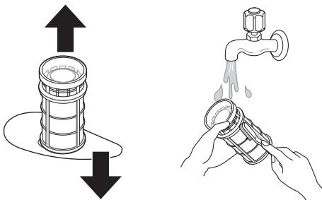
4 Pour remonter les filtres assemblés, positionnez le bras gicleur inférieur de sorte que le grand V soit orienté vers l'avant. Remontez les filtres dans le porte-filtre et fixez-les en tournant le filtre interne dans le sens des aiguilles d'une montre jusqu'à ce qu'il se verrouille en place.
