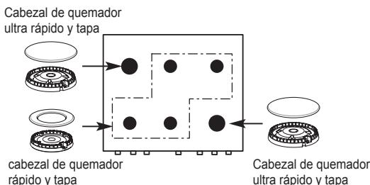
Asegúrese de que el agujero del cabezal del quemador esté ubicado sobre el electrodo.
