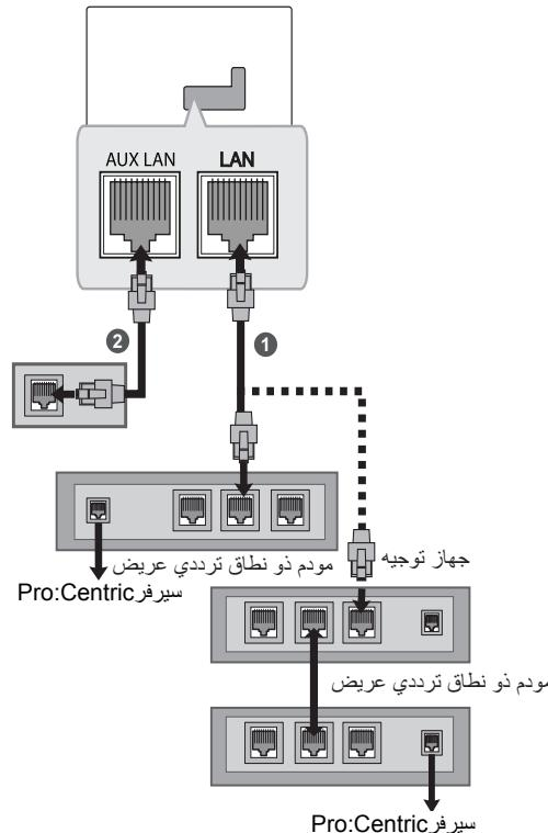
قم بتوسيط منفذ شبكة LAN الخاص بالمودم أو جهاز الرواتر بمنفذ LAN على التلفاز.
