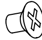
M3 x L6 Screws KT-T320 : 9 EA KT-T430 / KT-P430 : 14 EA KT-T490 / KT-T550 : 16 EA
