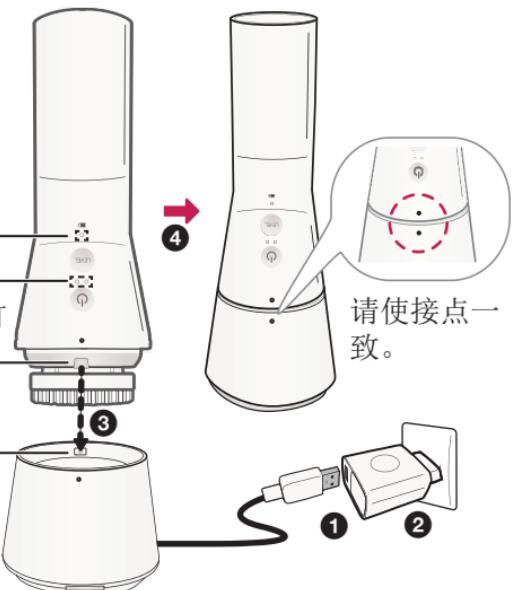
① 充电时, 请将本仪器准确安装到充电支架的接点上。(此时请与本机充电支架的点保持一致。)
