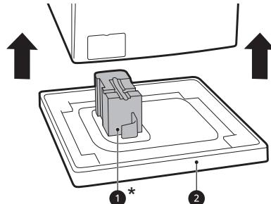
确保滚筒支架①\*与保护座一起脱离，而不是卡在本机的底部。
