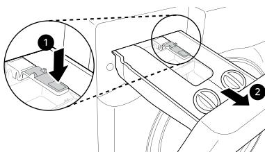
**4** 拆下止回阀，去除任何残留的洗涤剂 / 柔顺剂，然后关闭止回阀。
