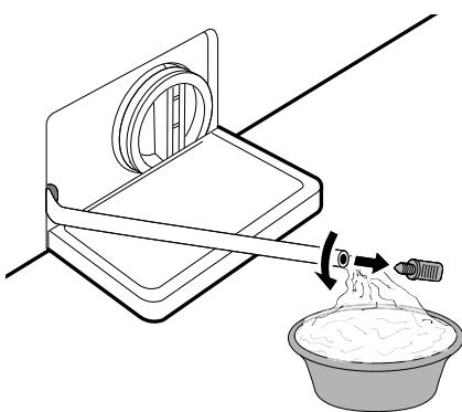
4 缓慢拧下排水泵过滤器以排出剩余的水，然后继续清除过滤器中的所有碎屑或物体。
