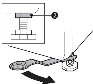
**4** 检查本电器底部的所有锁紧螺母是否均已正确拧紧。
