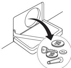
4 После очистки поверните фильтр насоса и вставьте пробку слива.
