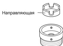
3 Наденьте адаптер на конец крана так, чтобы резиновое уплотнение создало герметичное соединение. Затяните четыре крепежных винта.
