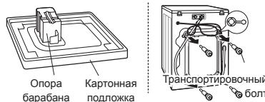
Снимите транспортировочные болты и опоры.
