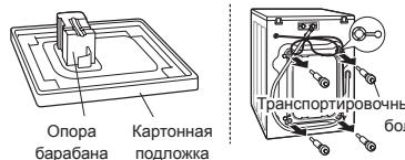
Снимите транспортировочные болты и опоры.
