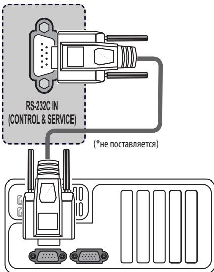
**Тип разъема: 9-контактный, вилка D-Sub**
