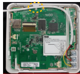
固定弯曲电缆的上部中心定位柱
