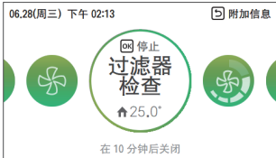
自动过滤器检查过程中的主屏显示
