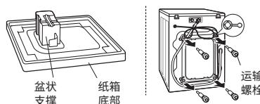
拆除运输螺栓和盆状支撑。
