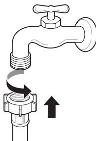
3 将接头往上推至水龙头末端, 从而使橡胶密封圈形成水密连接。拧紧四颗固定螺丝。
