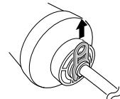
2 Saque la tubería del filtro de agua.
