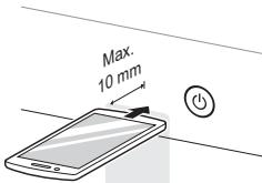
**3** Pulse y mantenga presionado el botón **Temperatura** durante 3 segundos o más mientras sostiene el micrófono del teléfono inteligente junto al botón **Encendido/Apagado** hasta que la transferencia de datos finalice.
