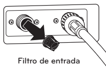
Filtro de entrada
