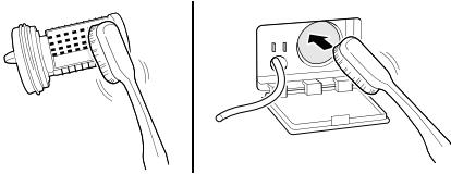
**6** Après avoir nettoyé le filtre de la pompe de vidange, réinsérez soigneusement le filtre et revissez le bouchon de vidange dans le sens des aiguilles d'une montre afin d'éviter les croisements de filets et les fuites.
