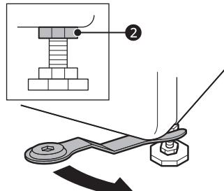
**4** Vérifiez que tous les écrous de blocage situés au bas de l'appareil sont correctement fixés.
