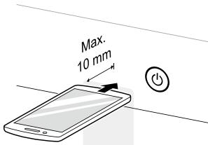
**3** Pulse y mantenga presionado el botón **Temp.**. **Lavado** durante 3 segundos o más mientras sostiene el micrófono del teléfono inteligente junto al botón **ENCENDIDO/APAGADO** hasta que la transferencia de datos finalice.
