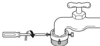
4 向上垂直推动进水管 ③，从而使水管中的橡胶密封圈能完全粘合水龙头，然后向右转动拧紧。
