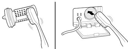
6 清洁排水泵过滤器后，小心地重新插入过滤器并顺时针拧紧排水盖，避免螺纹错扣和泄漏。
