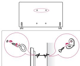
1 Insérez et serrez les boulons à œil, ou les supports et les boulons à l'arrière de la TV.
