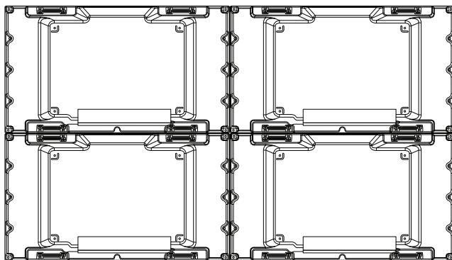
Модуль 4 соединен с остальными модулями (видеостена 2 x 2)
