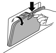
**2** Haal de stekker van de aftapplug en open het filter door het naar links te draaien.
