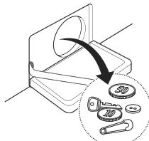
**4** Après nettoyage, tourner le filtre de la pompe et insérer le bouchon de vidange.
