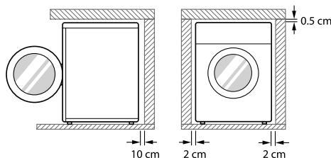
**Vlakke vloer** : Toegestane helling onder de hele wasmachine is 1°.
