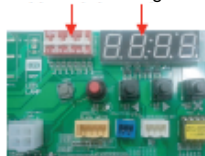
PCI da unidade de exterior
