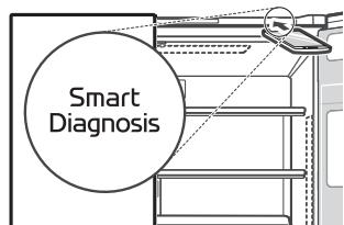
**3** 将手机保持在扬声器上，按住 **冷冻温度** 按钮三秒钟或更长时间，直到数据传输完成。
