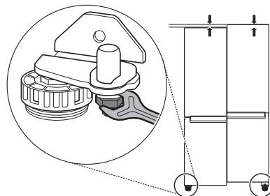
1 打开冰箱门，使用扳手 ① 向左转动止动螺母可将其松开。
