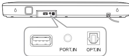
**USB** (solo servicio) ..... Conector de descarga de software.
