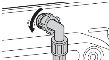
**2** Retire el filtro de entrada de agua con pinzas pequeñas y luego limpie el filtro utilizando un cepillo de diente de cerdas medianas.
