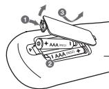
Снимите крышку отсека для батареи на задней части пульта дистанционного управления и вставьте две батареи, соблюдая полярность  $+$  и  $-$ .
