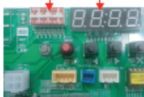
PCB de unidad exterior
