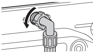
**2** 用小钳子拆下进水过滤器，然后使用中等硬度牙刷清理过滤器。
