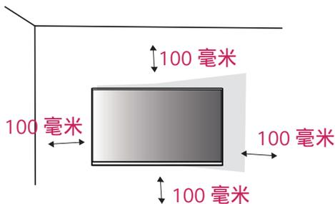
如果您想将显示器安装到墙上，请在显示器的背面加上墙式安装支架（可选）。
