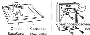
Снимите транспортировочные болты и опоры.
