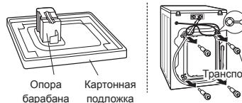
Снимите транспортировочные болты и опоры.
