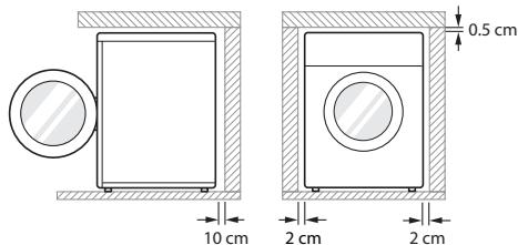
**Ровный пол** : допустимый уклон пола под всей занимаемой машиной площадью не должен превышать 1°.
