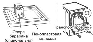
Снимите транспортировочные болты и опоры.
