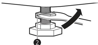
4 Убедитесь, что все стопорные гайки в нижней части машины надежно затянуты.
