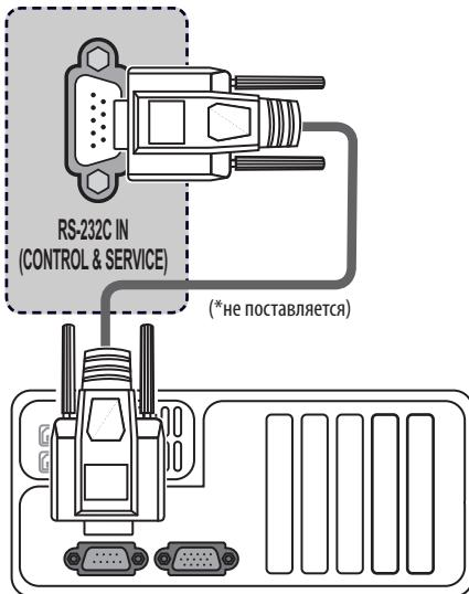
**Тип разъема: 9-контактный, вилка D-Sub**
