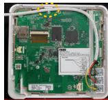
A saliência central superior para fixar o cabo dobrado
