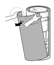
2 使用真空吸塵機或軟刷,清除濾網周圍前置濾網上的灰塵。
