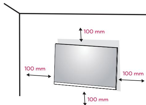
Afin d'installer le moniteur sur un mur, fixez un support de fixation murale (disponible en option) à l'arrière du moniteur.
