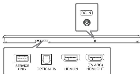
**DC IN** ····· Подключение сетевого блока питания.
