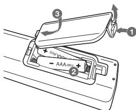
Retire la cubierta de las baterías que está en la parte posterior del control remoto e introduzca la batería de forma que **+** y **-** coincidan.
