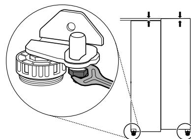
1 打开冰箱门, 使用扳手 1 向左转动止动螺母可将其松开。
