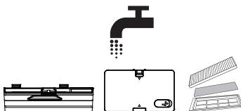
**8** Перед использованием полностью высушиите в сухом проветриваемом месте водяной насос, контейнер для пыли и фильтр в сборе.
