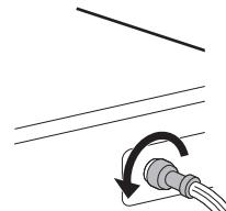
**2** Retirez le filtre d'arrivée d'eau avec une petite pince et nettoyez le filtre à l'aide d'une brosse à dents à poils medium.
