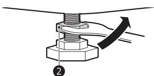
**4** Vérifiez que tous les écrous de blocage situés au bas de l'appareil sont correctement fixés.
