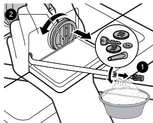
**4** Après avoir nettoyé le filtre de la pompe de vidange, réinsérez soigneusement le filtre et revissez le bouchon de vidange dans le sens des aiguilles d'une montre afin d'éviter des dommages au tube de vidange et des fuites. Réinsérez le bouchon dans le tuyau de vidange et placez le tuyau dans son support.
