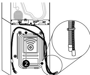
l'installation du tuyau de vidange à un évier, l'attacher fermement à l'aide d'une ficelle.
